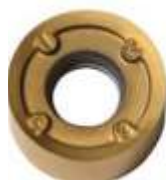
Rodeka 10 Inserto com IC de 10mm 8 arestas de corte
